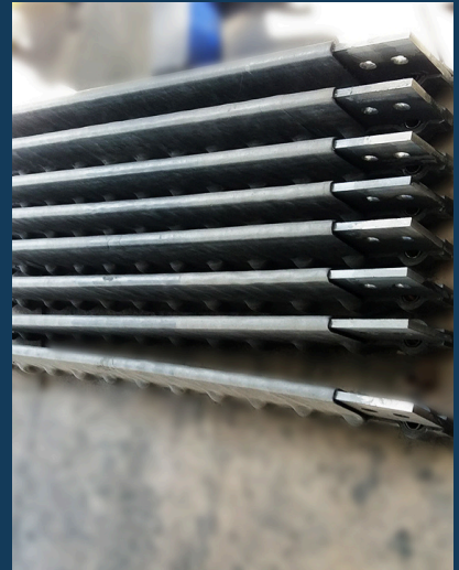
REVESTIMIENTO DE ALAVES AL CALIENTE
