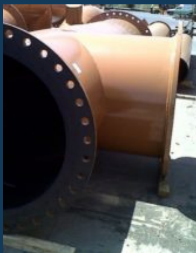
REVESTIMIENTO DE SPOOLS
