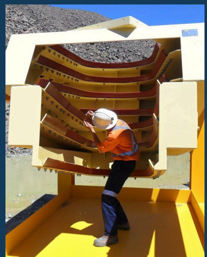
REVESTIMIENTO DE CHUTE DE DESCARGA
